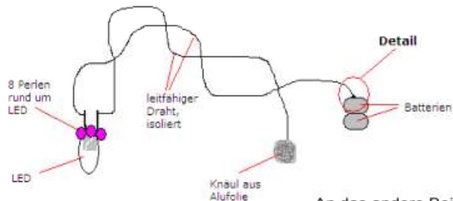
Ein Ende des Drahtes wird zu einer Spirale gewickelt und diese mit Isolierband auf die Batterie geklebt. Die Spirale soll für besseren Kontakt sorgen. Das andere Ende des Drahtes wird an einem Bein der LED befestigt (entweder löten, oder mit Isolierband festkleben).
